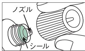
②初めて使用する時は、キャップ上部の突起部をノズルの穴にまっすぐ差し込み、内部のシールに穴を開けてお使いください。
